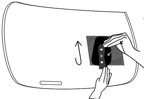
Sécurisez le capteur en attachant le passant. Le boîtier doit se situer à l'extérieur de la poche, et le lecteur de puce à l'intérieur.
